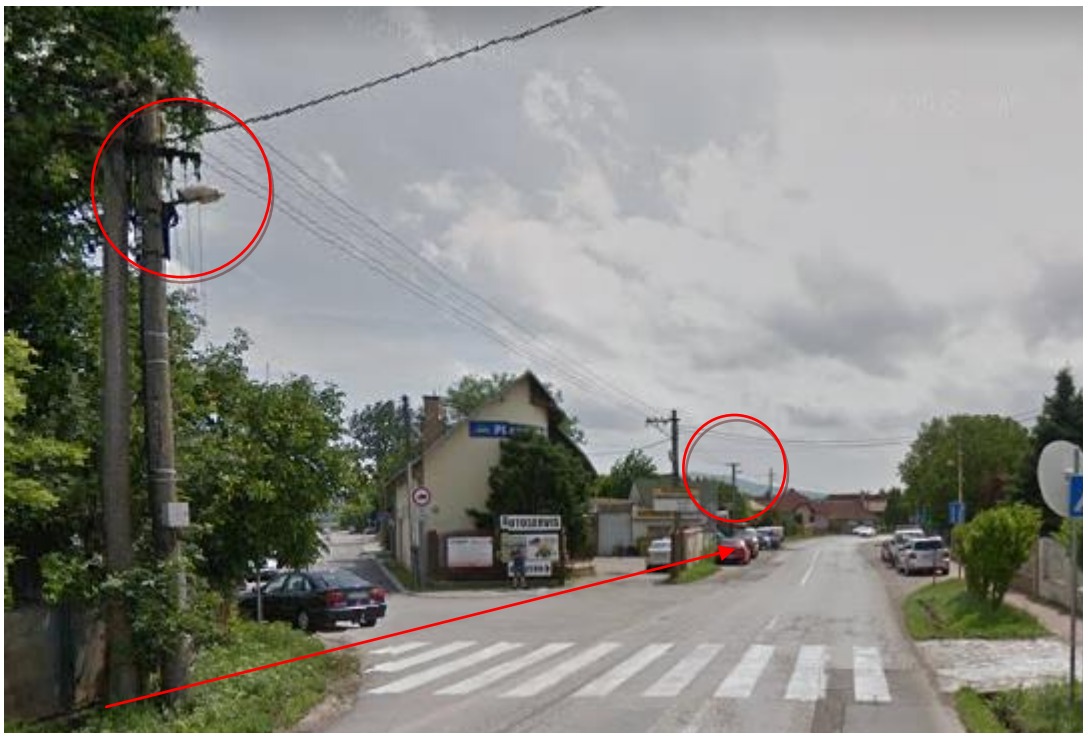
Obr. 5 Veľké rozostupy medzi svietidlami – vzdialenosť 80 m medzi stožiami
